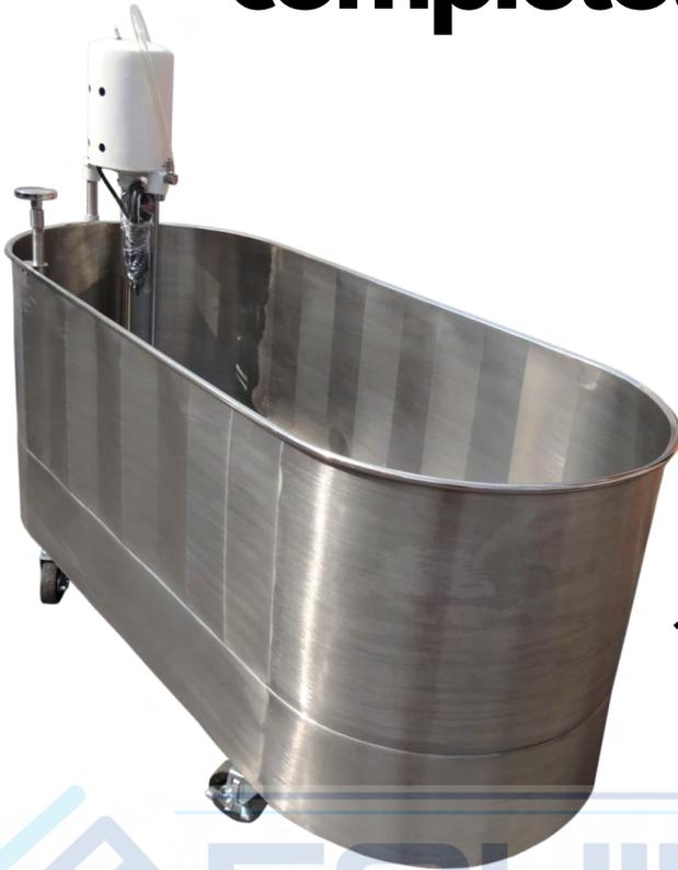
Tina remolino cuerpo completo fabricada en acero inoxidable tipo 304 con motor de 1/2 HP consumo 12 amp marca Hydrosmart, medidas generales 75 galones 133x61x46 (l x w x h ); 90 galones 84 cm de alto, 117 cm de largo, 61 cm ancho; 105 galones 71 cm alto, 167.5 cm largo, 63.5 cm ancho puede ser móvil o de tipo estacionario, 110-127v, desagüe por gravedad salidas de válvulas de 3/4.
